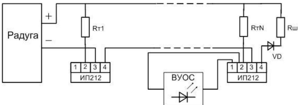
$R_{т1} - R_{тN} - 2,0 \text{ кОм}$  ;  $R_{ш} - 2,4 \text{ кОм}$ ; VD – КД522Б или КД510А
