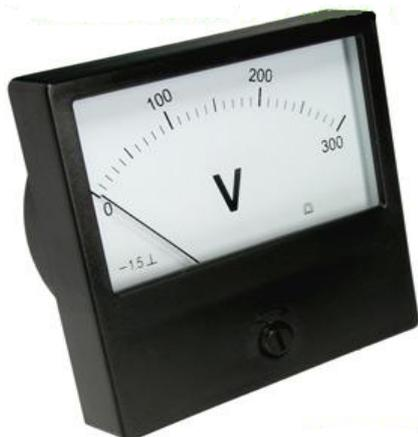
Прибор CG-80 предназначен для измерения напряжения в цепях постоянного тока. Индикатор представляет собой щитовой вольтметр магнитоэлектрической системы с подвижной рамкой и внутрирамочным магнитом. Исполнение приборов - устойчивое к воздействию пыли и брызг. Степень защиты корпусов – IP50 или IP54.
