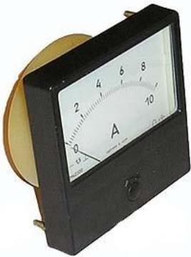
Амперметр М42300 предназначен для измерений тока в электрических цепях постоянного тока. Приборы представляют собой щитовые приборы магнитоэлектрической системы с внутрирамочным магнитом; Измерительный механизм прибора состоит из магнитной системы (обойма, магнитопровод), отсчетного устройства (шкала, указатель) и подвижной части на кернах;
