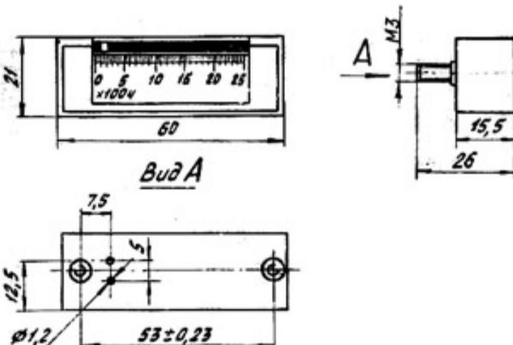
4.4. Отсчёт времени наработки производится по положению мениска катодного (левого) столбика ртути кулометра относительно пластины (см. рисунок).
