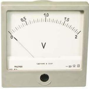
Вольтметр М42100 предназначен для измерения напряжения в электрических цепях постоянного тока. Габариты - 80x80мм, вырез в щите 77,5мм.
