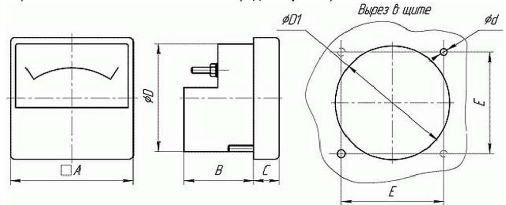
где А - 80мм, В - 36мм, С - 14мм, D - 69мм, D1 - 77,5мм, d - 3,4мм, E - 68мм;
