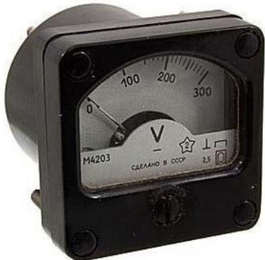
Вольтметры М4203 предназначены для измерения напряжения в цепях постоянного тока. Вольтметры М4203 используются при температуре окружающего воздуха от -40°C до +60°C и относительной влажности до 98% (при 35°C).
