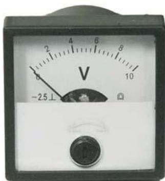
Амперметр CG-40 предназначен для измерения напряжения в цепях постоянного тока. Прибор представляют собой щитовой малогабаритный вольтметр магнитоэлектрической системы с подвижной рамкой и внутрирамочным магнитом.
