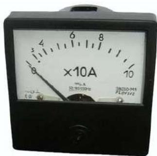
Амперметр Э8032 предназначен для измерения тока в цепях переменного тока на передвижных и стационарных объектах. Установочные размеры - вырез в щите 77,5 мм. Длина шкалы, не менее, 56мм.
