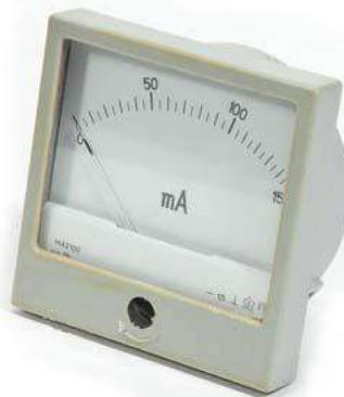
Миллиамперметр М42100 предназначен для измерения тока электрических цепей постоянного тока. Вибропрочные, ударопрочны.
