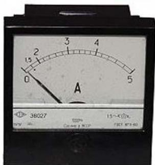
Амперметр Э8027 предназначен для измерения тока в цепях переменного тока на передвижных и стационарных объектах.
