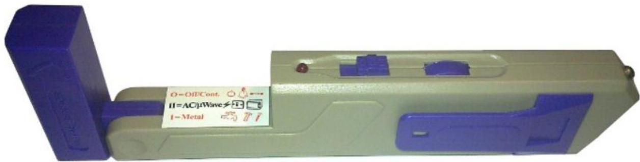
Детектор MEET MS-58АСМ предназначен для обнаружения металлических предметов, скрытой проводки и электромагнитного излучения.
