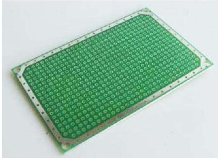
Размер 56 мм\* 86мм, шаг между отверстиями 2.54мм. Все отверстия отдельные. Диаметр отверстий 1мм. Площадки круглые. Обе стороны платы одинаковы. По всему периметру с обеих сторон "земля" имеющая соединения с другой стороны платы. В углах есть крепежные отверстия. Материал FR-4. Толщина 1.6мм.
