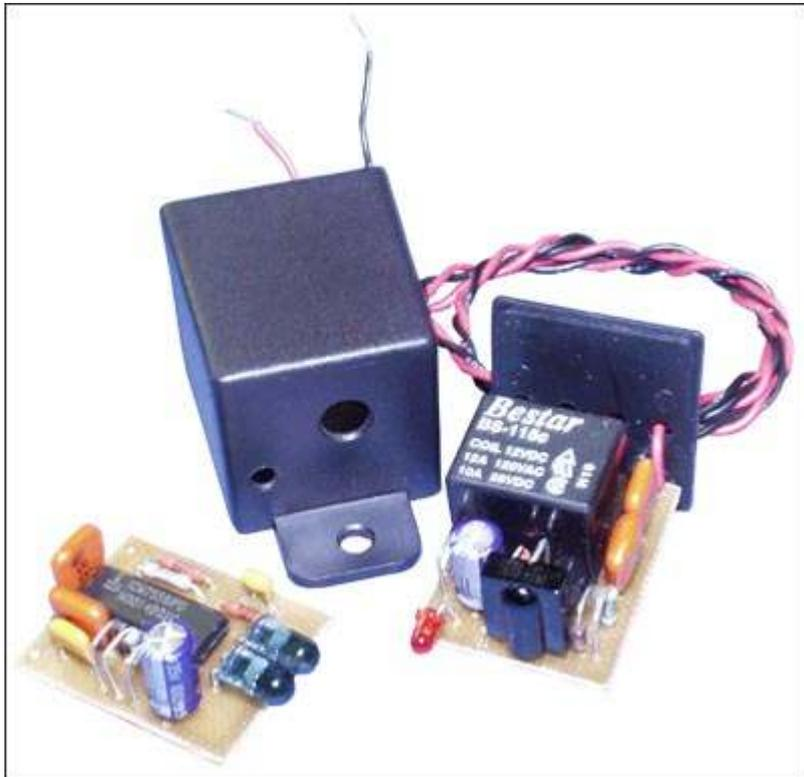
Устройство «Инфракрасный барьер» используется в качестве оптического датчика охранных систем. ИК-излучатель и фотоприемник располагаются друг напротив друга на расстоянии не более 18 м по границе охраняемой территории.
