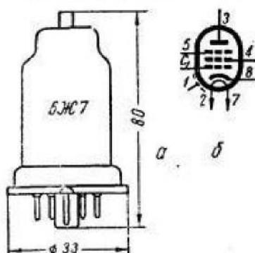
Предназначен для усиления напряжения высокой частоты.
