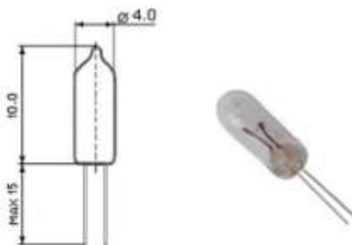
Лампа миниатюрная LE-ВТ03070 используется в радиоэлектронных приборах и устройствах в качестве индикаторных и осветительных элементов.
