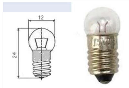
Миниатюрная лампа накаливания МН-6.3-0.3 применяется для освещения и подсветки шкал радиоэлектронных приборов, сигнализации, в карманных, портативных и батарейных фонарях, в велосипедных фарах и т.д.
