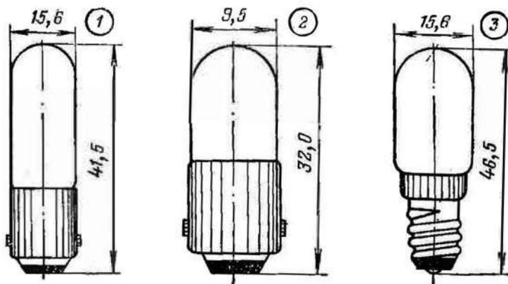
цвет свечения (З — зеленый, Г — голубой, О — оранжевый), первая цифра после букв обозначает номинальный ток через лампу в миллиамперах (приближенное значение), вторая цифра условно характеризует напряжение зажигания лампы в сотнях вольт.
