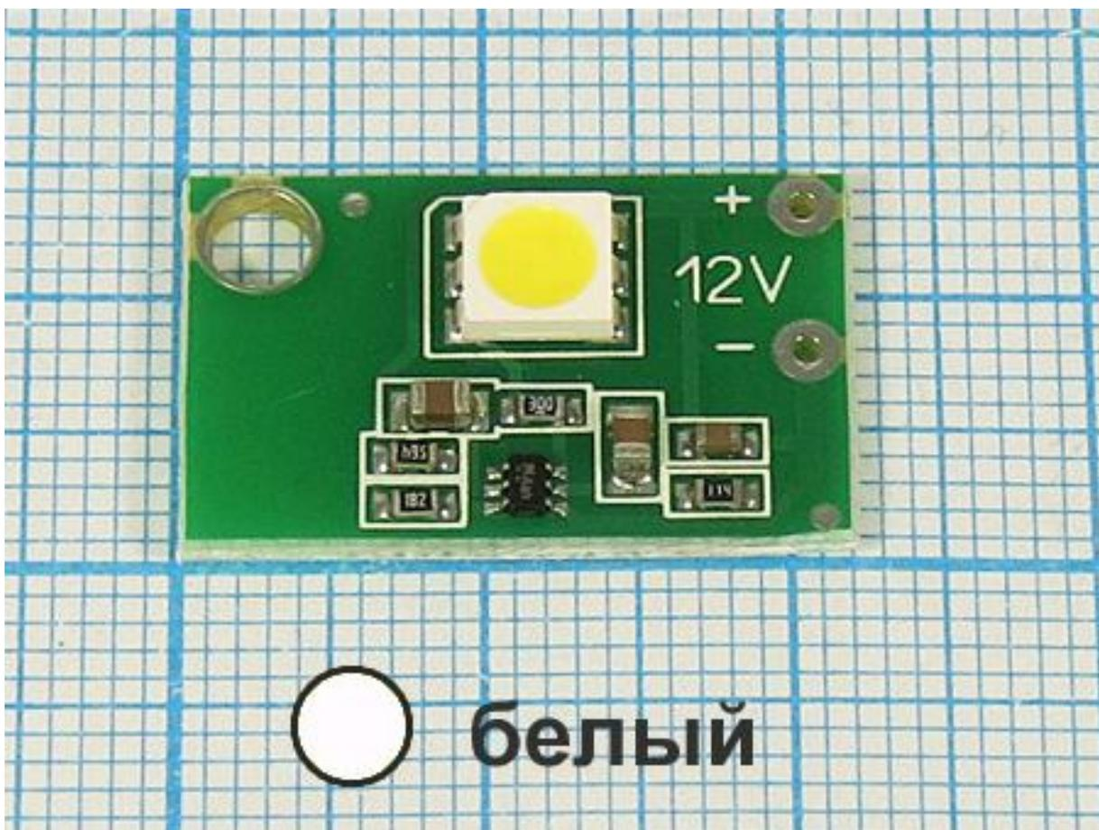
Стробоскоп светодиодный - это модуль состоящий из платы с ярким светодиодом. Стробоскопы применяются в различных областях. Для декорации витрин и привлечения внимания покупателей, в рекламных конструкциях, в клубах, на дискотеках и т.д. и т.д..
