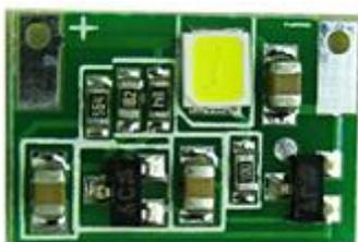
Стробоскоп светодиодный - это модуль состоящий из платы с ярким светодиодом. Стробоскопы применяются в различных областях. Для декорации витрин и привлечения внимания покупателей, в рекламных конструкциях, в клубах, на дискотеках и т.д. и т.д. Светодиодные стробоскопы отличаются малыми размерами, надежностью, низким энергопотреблением, низким напряжением питания, высокой яркостью вспышки и продолжительным ресурсом работы.
