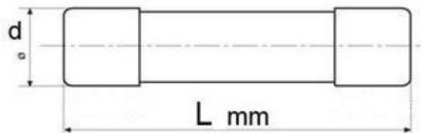
Предохранитель стеклянный, L = 38 мм, диаметр d = 10.3 мм. Номинальное напряжение 250 вольт.
