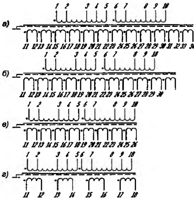
Рис 2 9. Электрические схемы трансформаторов типа ТПП2 с частотой питающей сети 50 Гц: а — ТПП2; б — ТПП2 2; в — ТПП2 3; г — ТПП2 5.
