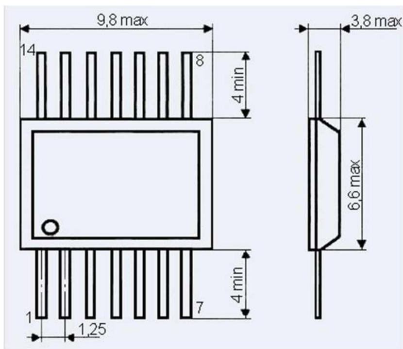
Блоки Б18 (конденсаторные сборки) предназначены для работы в цепях постоянного и переменного токов и в импульсных режимах. Основное назначение блоков - использование в устройствах вычислительной техники совместно с интегральными микросхемами и резисторными блоками.
