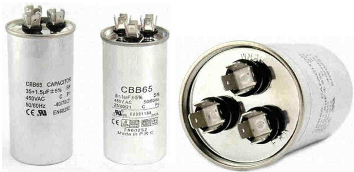
Номинальная емкость конденсаторов составляет 15 мкФ – 100 мкФ (для компрессора) и 1,5 мкФ – 6,0 мкФ (для вентилятора) при напряжении 450 В переменного тока частотой 50/60 Гц. Допустимое отклонение ёмкости  $\pm 5\%$ . Диапазон рабочих температур - 40°C...+70°C. Другие серии сдвоенных конденсаторов: СВВ65А-1, СВВ65А-2.
