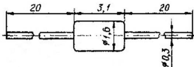
Варикап предназначен для работы в УКВ блоках автомобильных приемников и магнитол.
