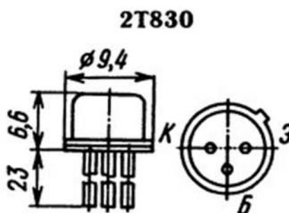
Транзисторы КТ830А кремниевые мезаэпитаксиально-планарные структуры р-п-р. Предназначены для применения в усилителях мощности, источниках вторичного электропитания, преобразователях.
