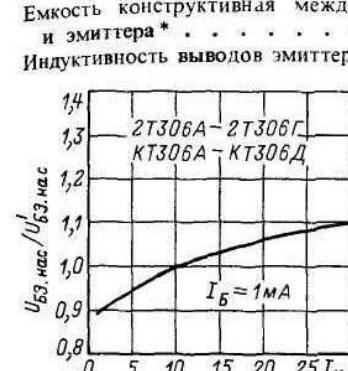
Зависимость относительного напряжения насыщения коллектор-эмиттер от тока коллектора.
