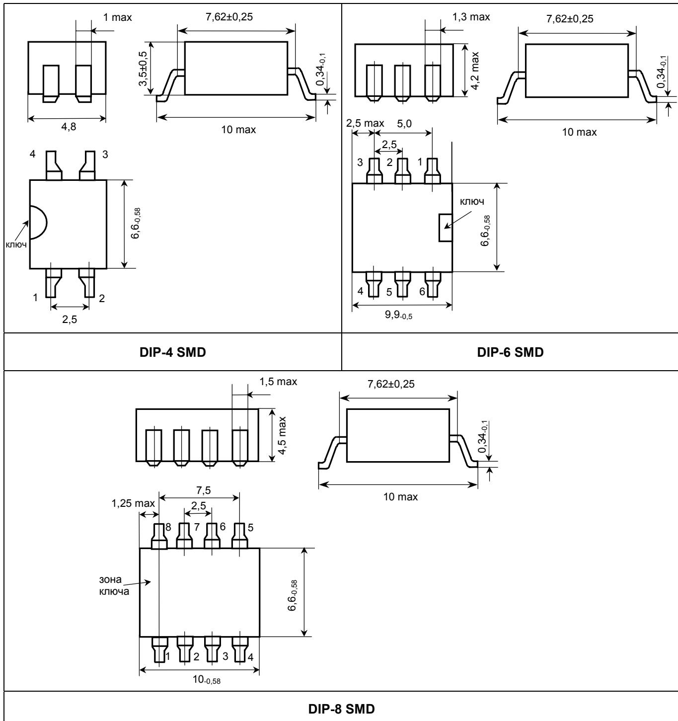
Для изделий КР249, КР293, К4499 в корпусах DIP4, 6, 8 буква Т в конце обозначает исполнение корпуса для SMD.
