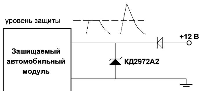
**Рисунок 1. Схема применения КД2972 для защиты**
