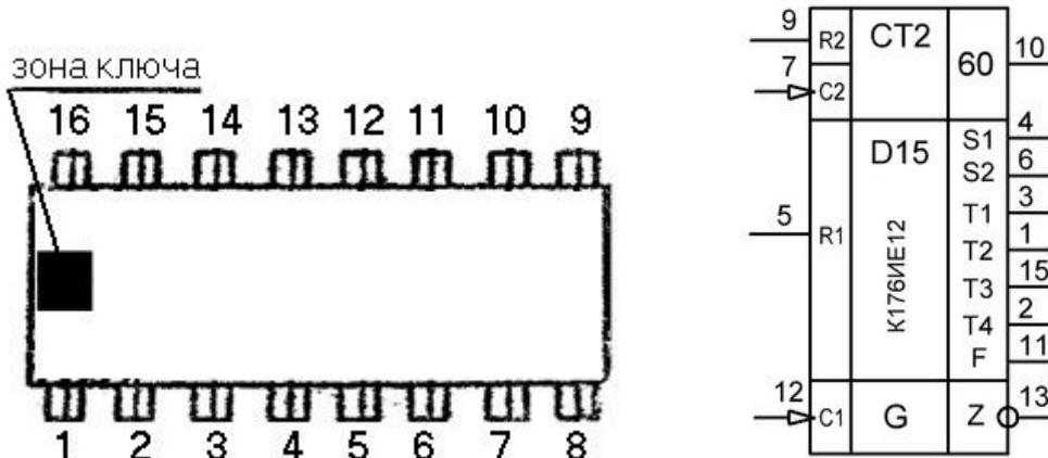
Расположение выводов и условное графическое обозначение.
