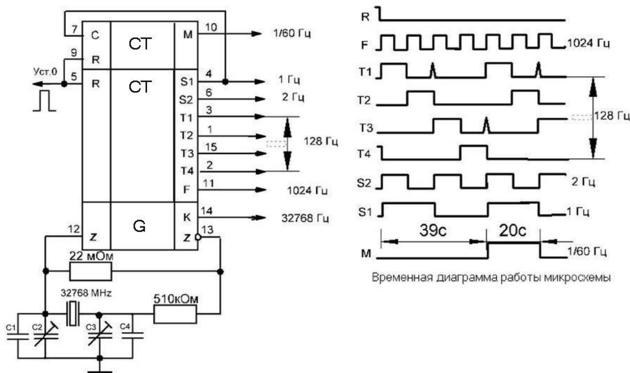
Фазовые соотношения колебаний различных частот относительно момента снятия сигнала сброса продемонстрированы на рисунке, временные масштабы различных диаграмм на этом рисунке различны. При использовании импульсов с выходов T1 - T4 для других целей следует обратить внимание на наличие коротких ложных импульсов на этих выходах.
