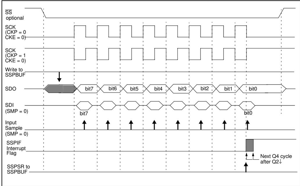
**FIGURE 15-12: SPI MODE WAVEFORM (SLAVE MODE WITH CKE = 1)**
