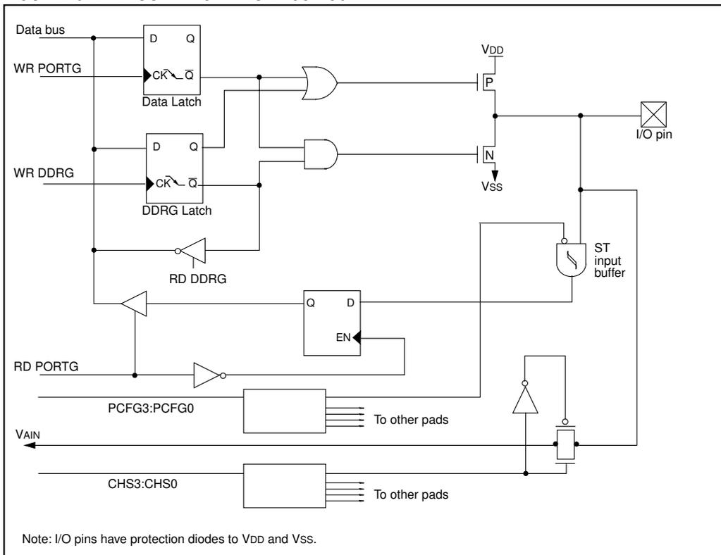
**FIGURE 10-15: RG4 BLOCK DIAGRAM**
