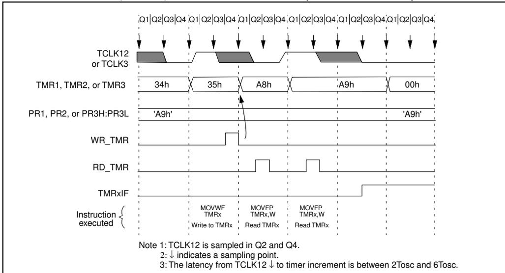
**FIGURE 13-11: TIMER1, TIMER2, AND TIMER3 OPERATION (IN TIMER MODE)**
