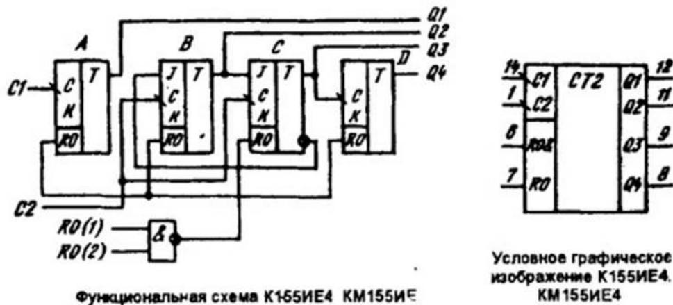
входные импульсы подают на вход C2 (выводы C1 и C2 не соединяют). Корпус К155ИЕ4 типа 201.14-1, масса не более 1 г, КМ155ИЕ4 — типа 201.14-8, масса не более 2,2 г
