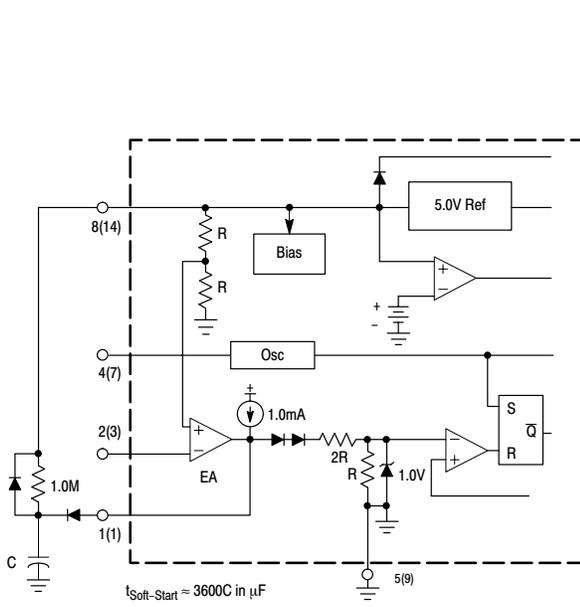
Figure 24. Soft-Start Circuit
