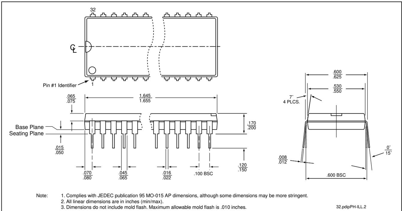
**32-PIN PLASTIC DUAL-IN-LINE PACKAGE (PDIP)**
