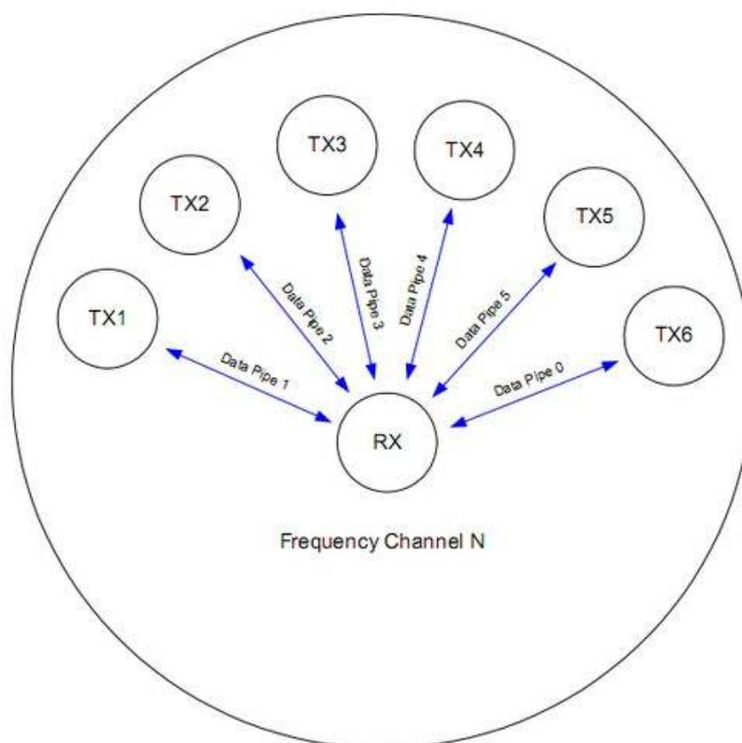
По умолчанию модуль приемопередатчика 2,4 ГГц NRF24L01 сконфигурирован как ведущий и может получать данные по шести каналам. Каждый из шести ведомых модулей должен быть сконфигурирован соответствующим образом, при этом ведомым модулям присваиваются уникальные адреса.
