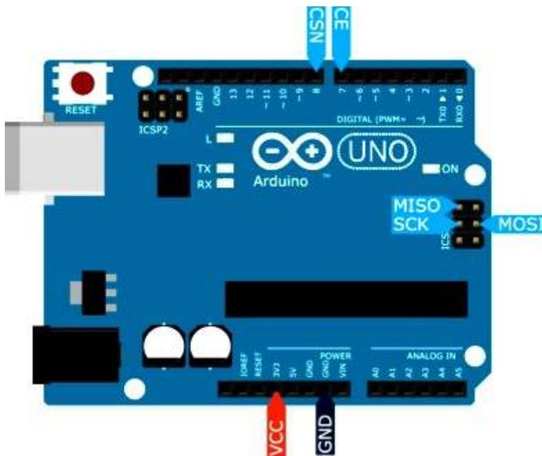
Подключение является универсальным и подходит для всех плат Arduino UNO, DUE, MEGA, Леонардо, Yun и подобных. Сигналы SPI выведены на соединитель ICSP микроконтроллерного модуля Arduino. Контакт питания VCC соединяется с контактом стабилизатора Arduino напряжения 3,3 В. Общий провод подключается к контакту GND. Сигналы выбора CE и CSN подключаются к контактам, определенным в библиотеке RF24, например 7 и 8.
