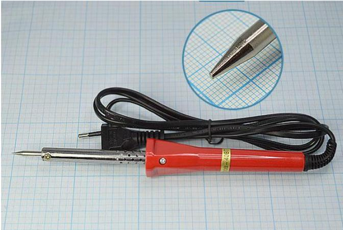
Паяльник мощностью 60Вт предназначен для ручного монтажа/демонтажа электронных компонентов и других деталей среднего размера. Подходит как для любительского, так и для профессионального использования. Долговечное жало паяльника состоит из медьсодержащего сердечника, покрытого слоем хрома. В случае необходимости его можно легко и быстро заменить (сменное жало в комплект не входит).
