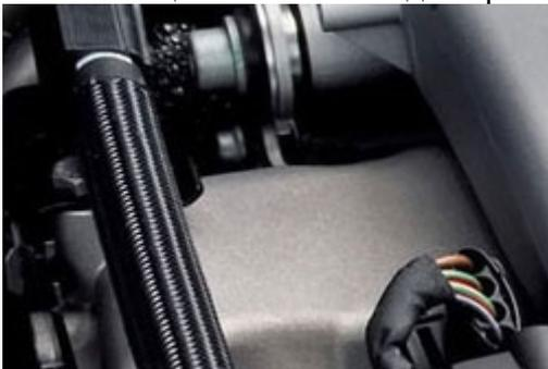
Применение гибкой оплётки под капотом автомобилей
