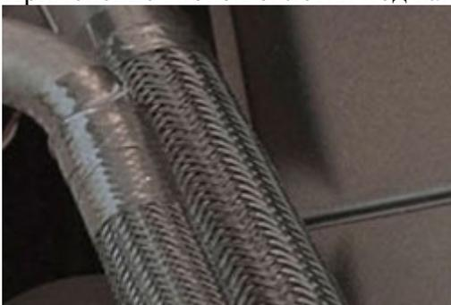
Применение гибкой оплётки под капотом автомобилей
