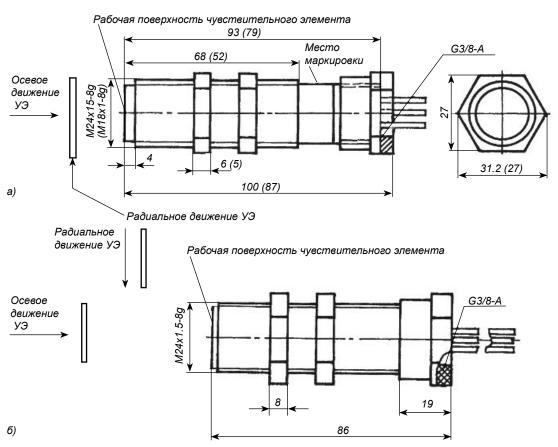
Размеры переключателей с переходной гайкой (с резьбой) для вывода проводов с помощью любых концевых соединений (прямых, угловых):
