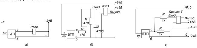
а – к электромагнитному реле; б – к логическим элементам серии 511; в – к логическим элементам «Логика Т»; цвета подключающих проводов: кр – красный (оранжевый), с – синий (голубой, зеленый), б – белый.
