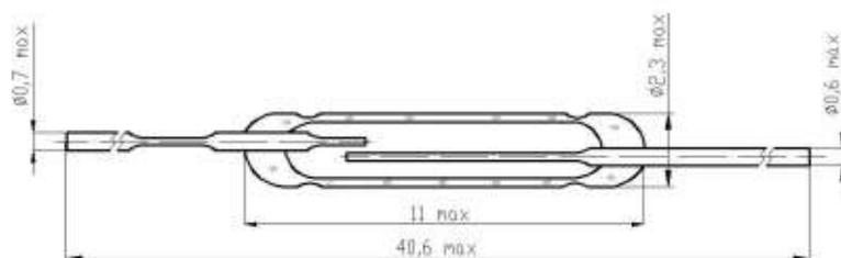
Применение: управляемые контакты реле, магнитные выключатели, различные датчики в бытовой, промышленной и специальной аппаратуре.
