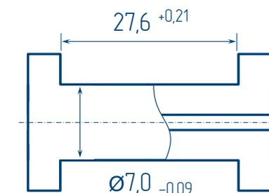
5000 витков, провод  $\varnothing$  0,08 мм
