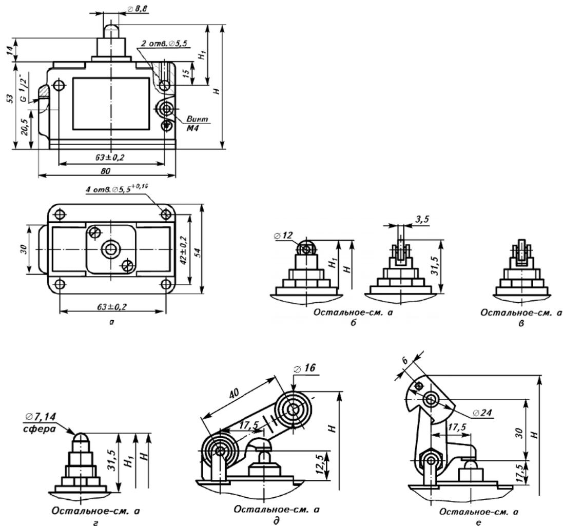
Рис. 8. **Общий вид, габаритные, установочные и присоединительные размеры микровыключателей со степенью защиты IP54, с торцевым креплением на поверхности, с монтажом проводов винтами или пайкой, с приводом:**
