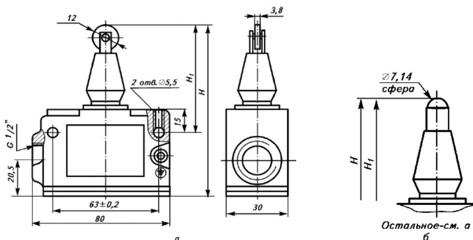
Рис. 9. **Габаритные, установочные и присоединительные размеры микровыключателей со степенью защиты IP54 с комбинированным креплением на поверхности, с монтажом проводов винтами или пайкой с приводом:**
