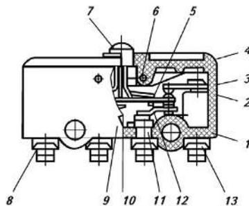
Рис. 1. Конструкция микровыключателя базового исполнения типа МП1101Л[\*][\*][\*].[\*][\*][\*][\*]
