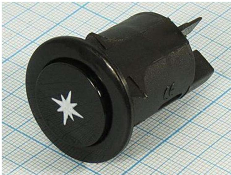
**Кнопка предназначена для коммутации электрических цепей с рабочим напряжением 250 вольт и током нагрузки до 16 ампер. Посадочный диаметр крепления кнопки на панель 24 мм.**
