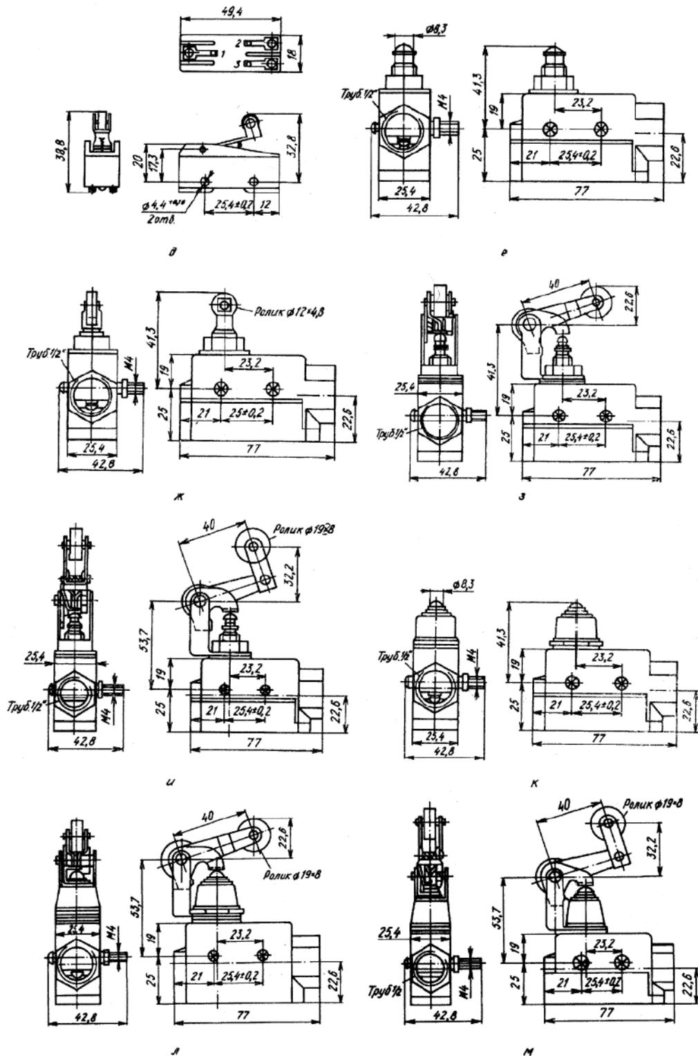
Рис. 2. Общий вид, габаритные, установочные и присоединительные размеры выключателей:
