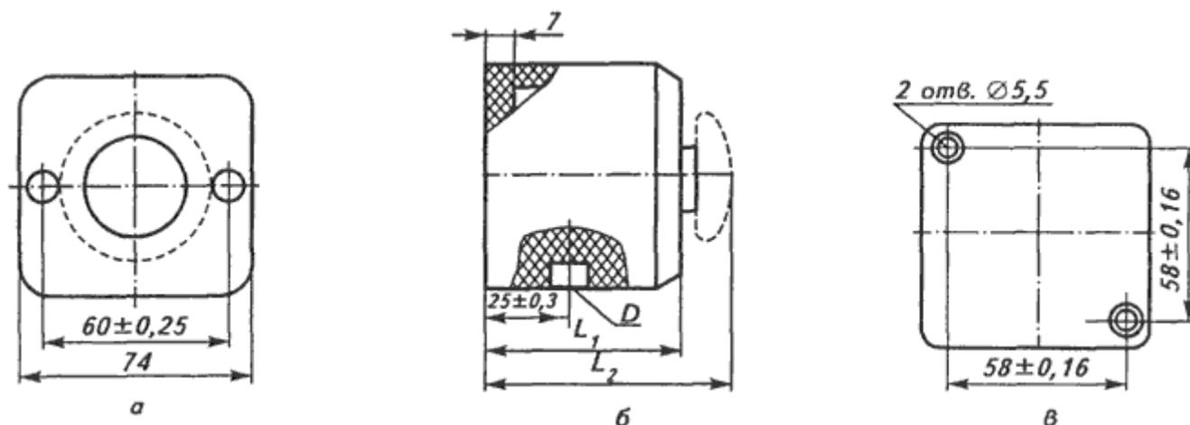
Рис. 4. Габаритные и установочные размеры постов управления серии ПКЕ с одним управляющим элементом для пристройки к любой ровной поверхности
