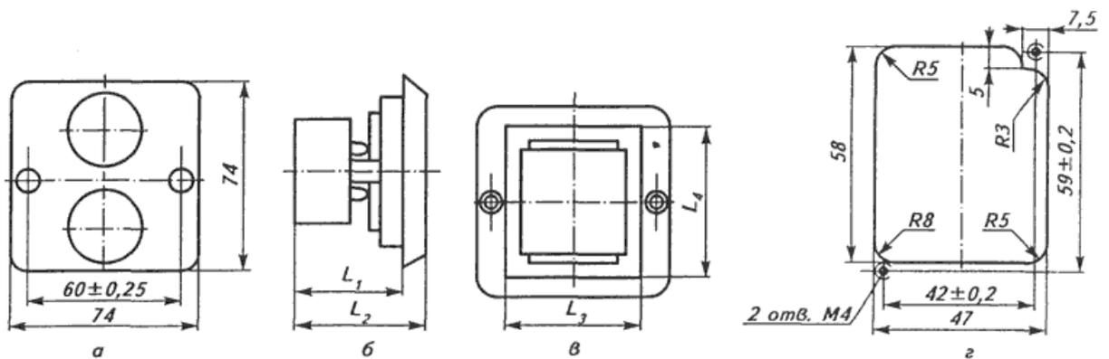
Рис. 6. Габаритные и установочные размеры постов управления серии ПКЕ "Пуск"- "Стоп" и ниши для пристройки
