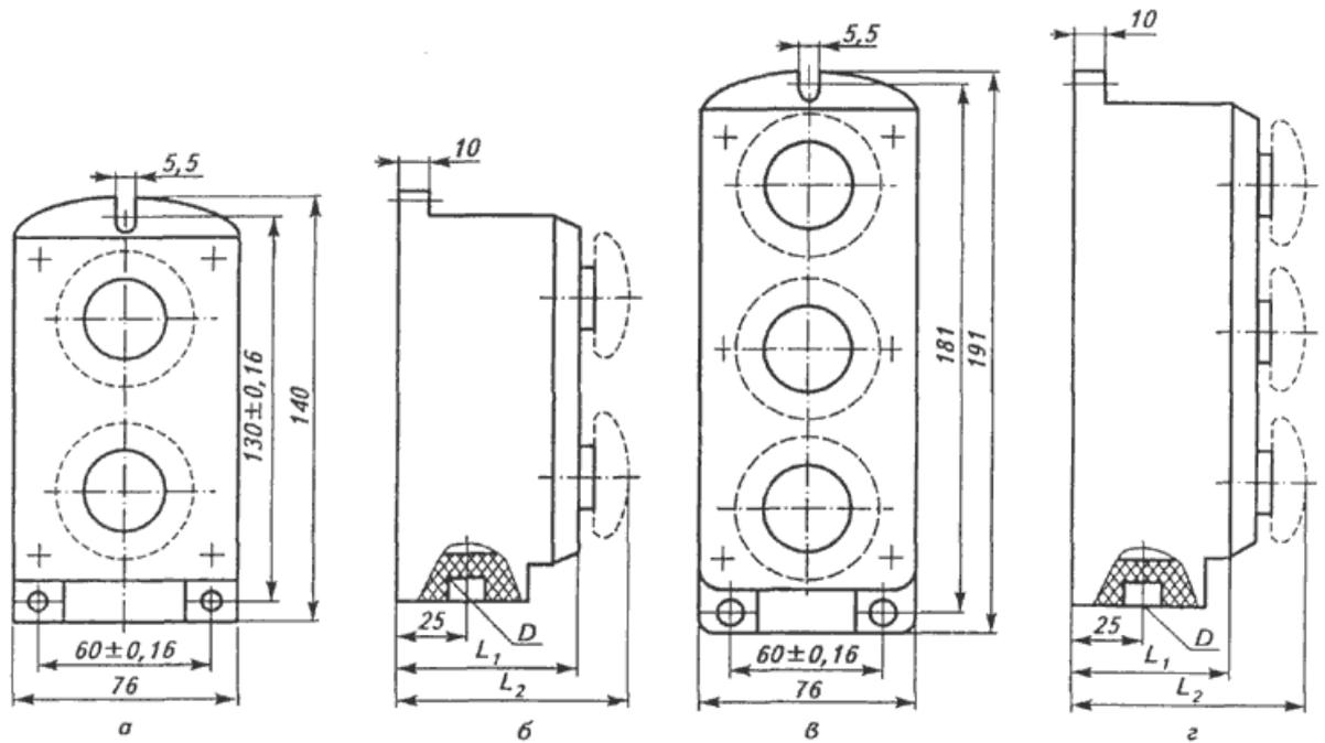
Рис. 5. Габаритные и установочные размеры постов управления серии ПКЕ с двумя и тремя управляющими элементами для пристройки к любой ровной поверхности
