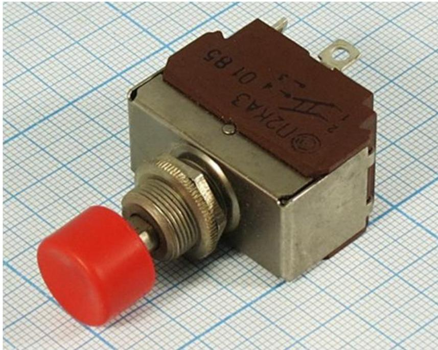
**Переключатель предназначен для коммутации электрических цепей с рабочим напряжением 250 вольт и током нагрузки до 5 ампер. Посадочный диаметр на приборную панель 12,2 мм.**
