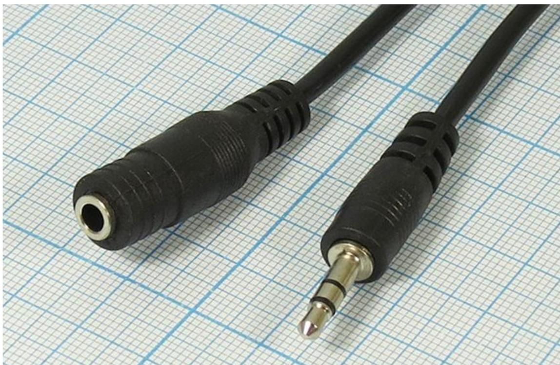
**Шнур имеет длину 1,5 метра. С одной стороны заделан гнездом 3,5 мм (3 контакта Ni), с другой стороны штекером 3,5 мм (3 контакта Ni).**
