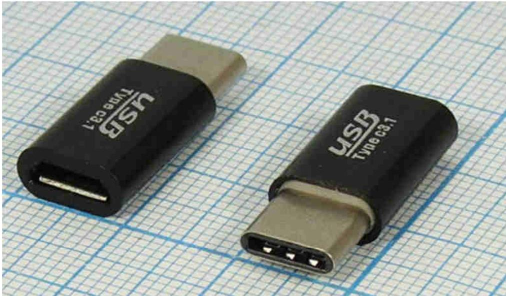
Переходник предназначен для сопряжения устройств стандарта micro-USB C 3.1 с устройствами стандарта micro-USB B.
