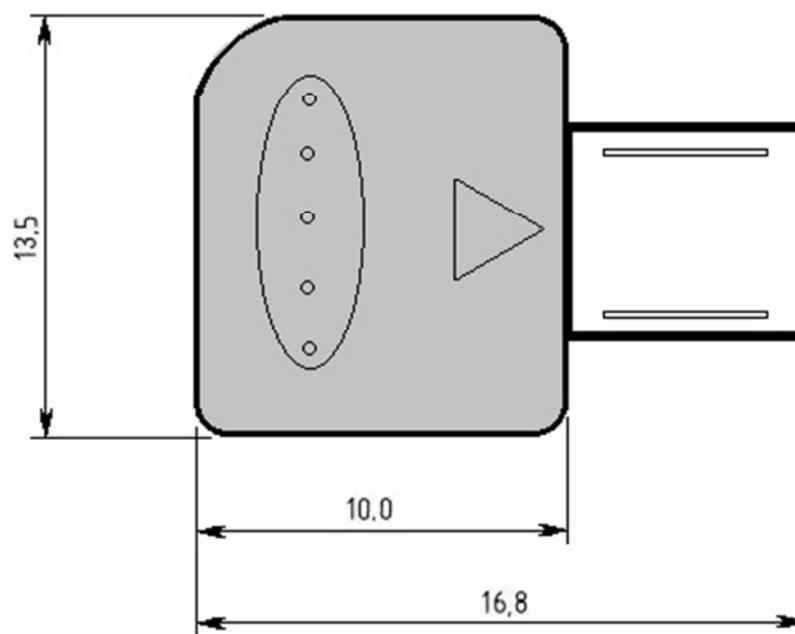
**Рекомендуемый диаметр кабеля 3,8 - 4,0 мм.**
