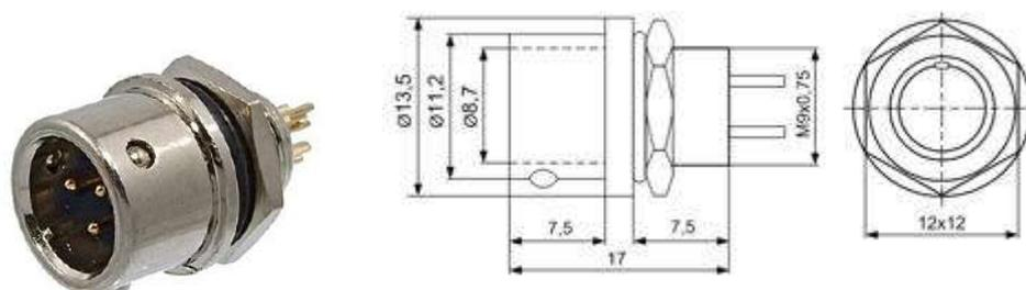
Разъемы быстроразъемные серии XS9 с посадочным диаметром 9 мм – коннекторы ручного соединения, цилиндрические, внутреннего объемного монтажа, для цепей с нагрузкой до 5А и 250В. Разъемы XS являются пылезащищенными и соответствуют степени защиты IP54.
