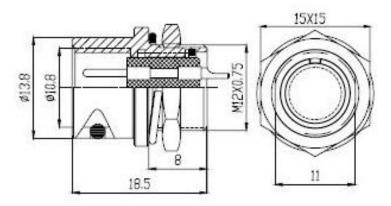
Разъемы быстроразъемные серии XS12, посадочный диаметр 12 мм – коннекторы ручного соединения круглые, внутреннего объемного монтажа, соединяют цепи с нагрузкой до 3A и 250В. Соединители серии XS насчитывают от 3 до 7 контактов.. Тип корпуса разъемов XS – на кабель или на панель. Вид соединителя серии XS: штекер или гнездо.
