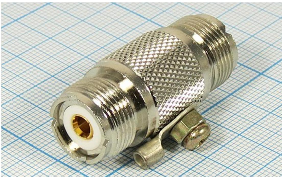
**Предназначен для стыковки кабелей и приборов, имеющих соответствующие ответные части ВЧ разъемов стандарта UHF. Переходник имеет позолоченный центральный проводник и хромированный корпус. Изолятор, как правило, изготавливается из фторопласта или из бакелита. Основное назначение - различная аппаратура СВ и КВ диапазонов.**
